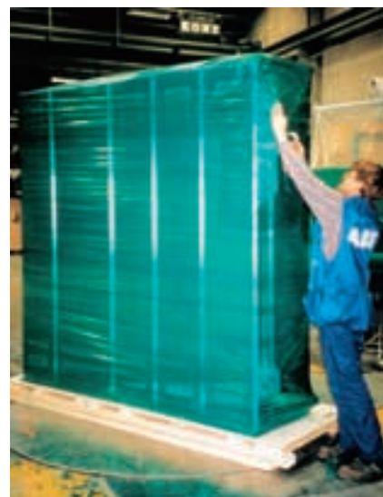
Elskåp förpackat med ZERUST® Valeno sträckfilm.
